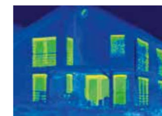
Nachher Energieverlust wird nahezu vollständig vermieden
